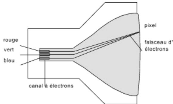
L'image apparaissant sur l'écran est formée de points lumineux ou non selon la stimulation ou l'absence de stimulation par le faisceau d'électrons. Les points ainsi obtenus sont appelés des pixels.
